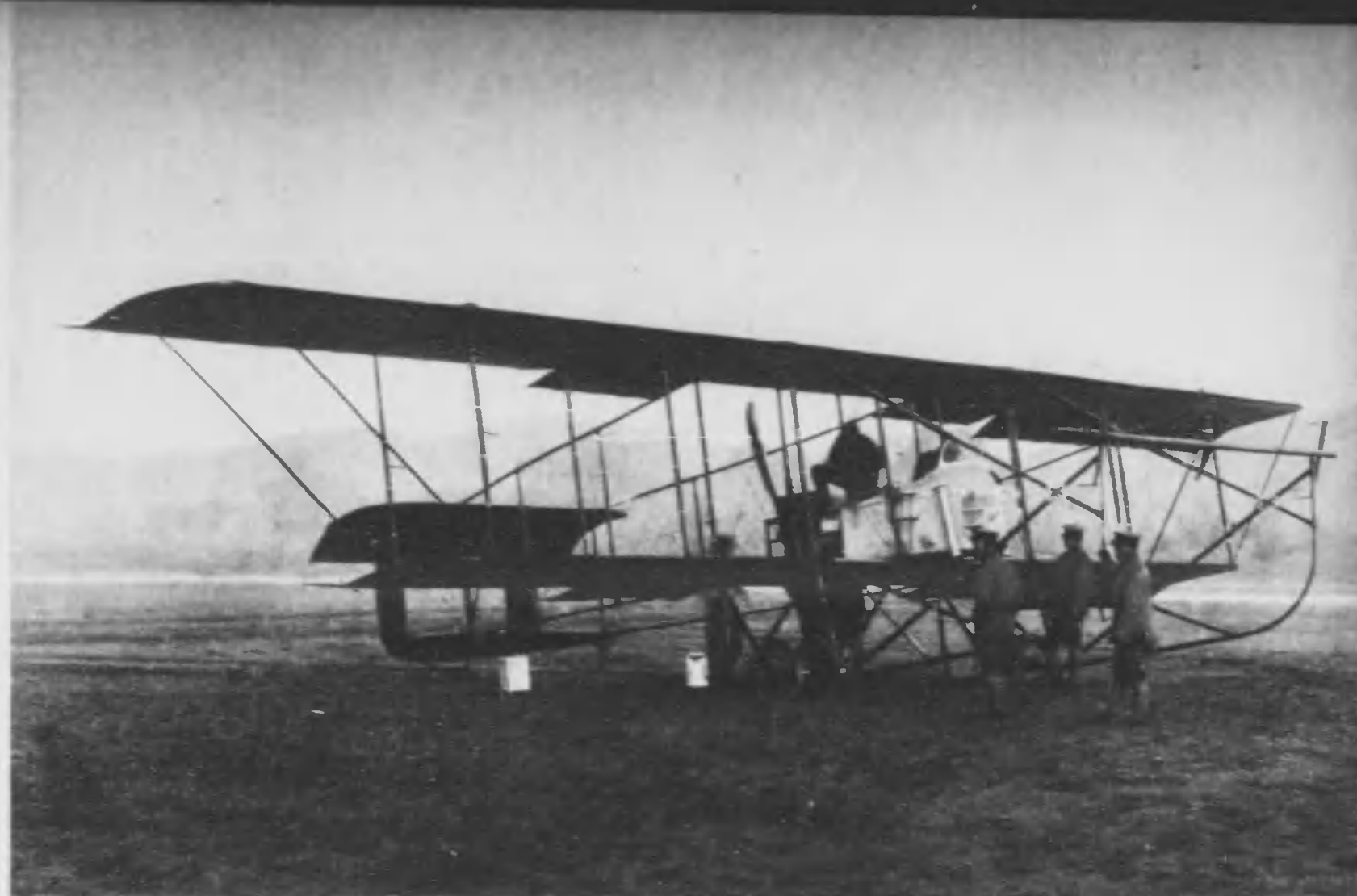
↑ 張村に向け出動せんとする我モリス・フ アルマン機 これは、實戦に参加した最初の我軍用機 で、プロペラは主翼の後ろに、兩翼の間 は蜘蛛の巣の様に針金を張り、かうした 幼雅な飛行機であつたが、それでも砲撃や うの爆弾を搭載して果敢な進軍を試みた。 今次事變に活躍する我空軍に比べると真に 今昔の感に堪えぬものがある。 (大正三年十月三十一日)
