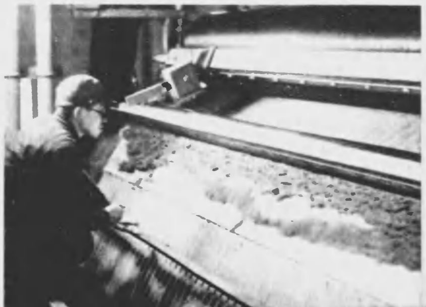
ドロドロになつたバルブの流動性を導引機機にかけて水分をとる
