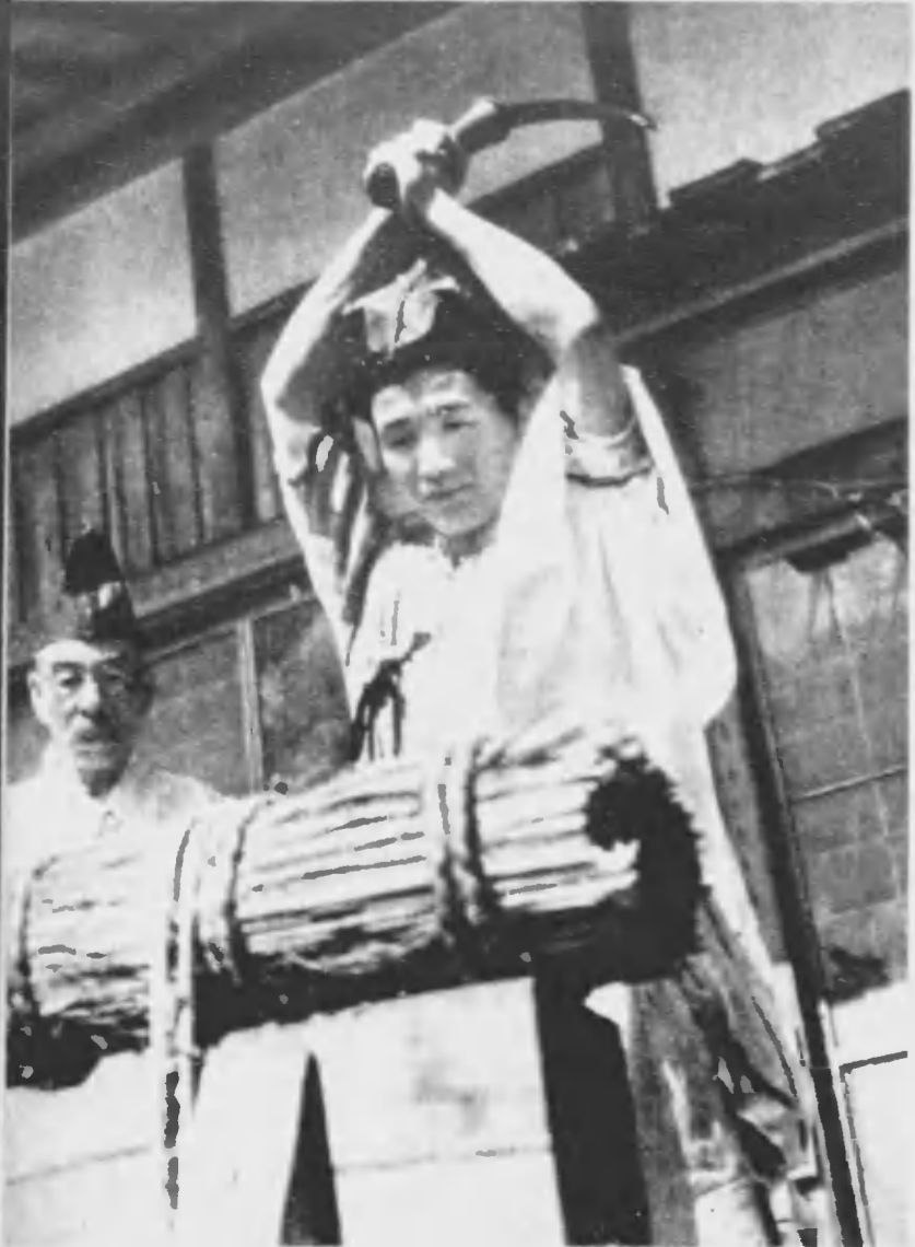
⇐ 刀匠の丹精こゝに決する焼入の場。堅傳の湯加減にジユツと突き込みの瞬間白煙があがる。
