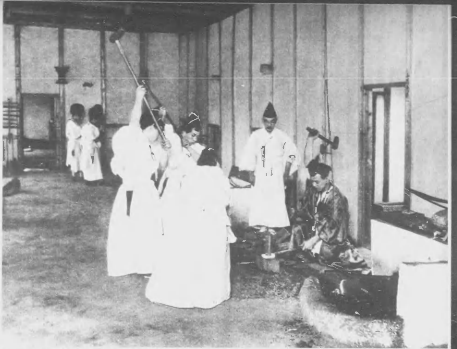
【 然し切つた砥石の玉を打つては延ばし、仕上げは折れ鍛錬の作業に塾生たちは一心不乱。
