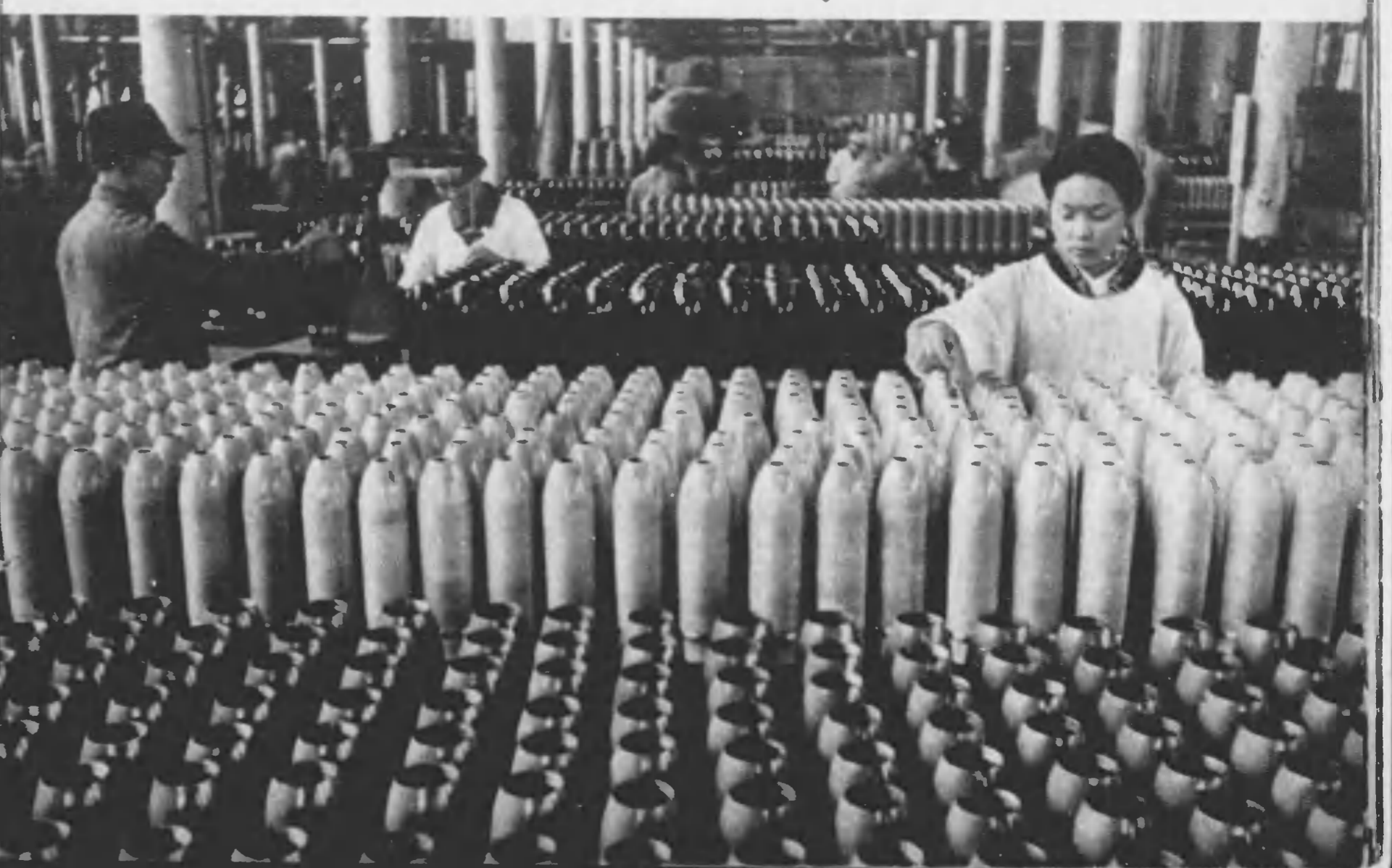
早い速度で旋廻し ながら徹甲弾の一 外面削り。流線型 の美しい姿が大き な弾を畫いて着弾 を減つて飛ぶ日が 目に浮かぶ
