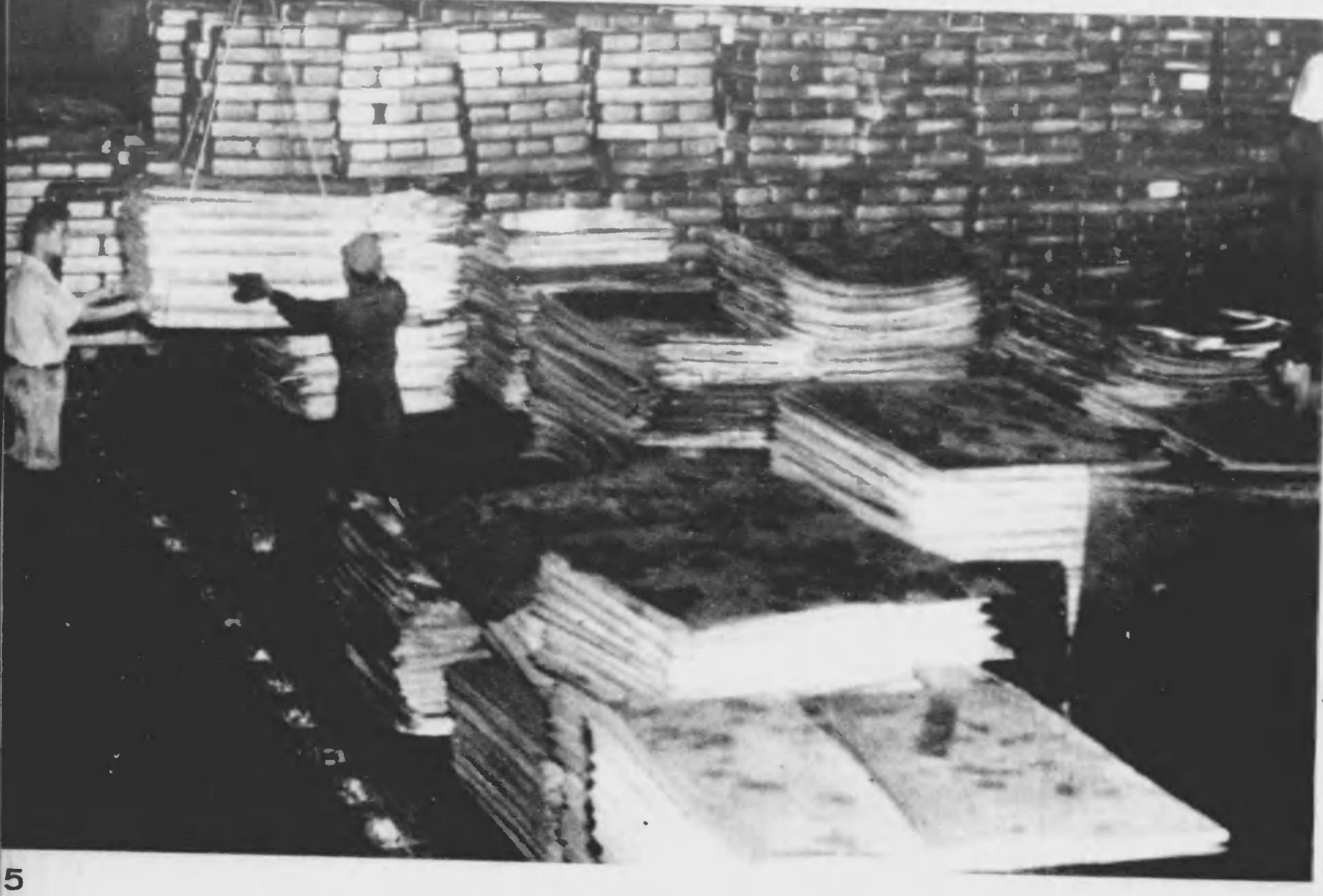
度の一枚一てれらけかに機延機はンミルラヂの状瓦煉 度百五氏攝みとし熔をンガンマとムウシネグマと銅にムウ=ミルア純 るれら根もに體嗣もに翼にぐすがたこ るなと板いす る上米出がンミルラヂい強ひ行を便時れ人焼し入投に水らか位 るれか菜と山に開く橋は板延たれさ延板のンミルラヂに形のまま
