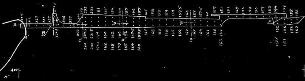
断面A-Aノウィカース硬度 --- 顕微鏡組織撮影位置ノ示
