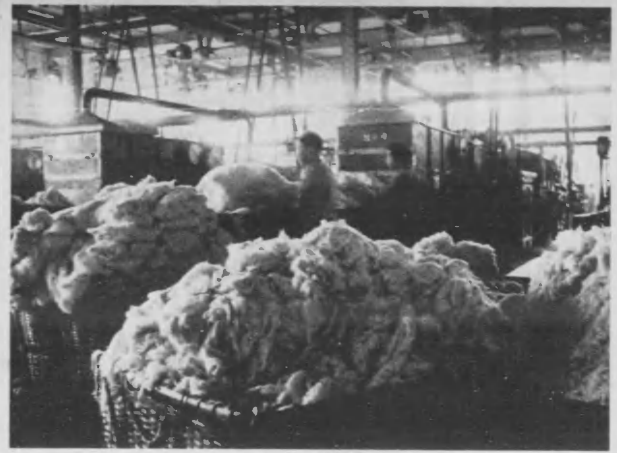
加工場は黄色がかった原色を白色に晒す。純白の綿は紡がれ綿糸となる。
